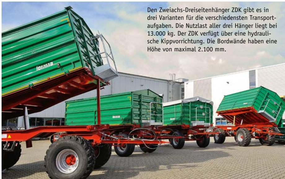
Den Zweiachs-Dreiseitenhänger ZDK gibt es in drei Varianten für die verschiedensten Transportaufgaben. Die Nutzlast aller drei Hänger liegt bei 13.000 kg. Der ZDK verfügt über eine hydraulische Kippvorrichtung. Die Bordwände haben eine Höhe von maximal 2.100 mm.
