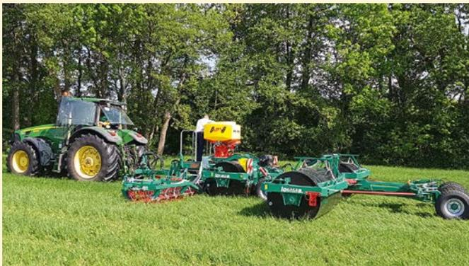
Alle Walzen können mit Planierschiene, Grob- und Feinstriegel sowie Saateinrichtung ausgerüstet werden. Wildschäden und Maulwurfshügel werden mit der Planierschiene problemlos eingeebnet. Die Striegel dienen der besseren Durchlüftung der Grasnarbe sowie der optimalen Einarbeitung der Grasnachsaat. Ein weiterer Vorteil der Lomma Wiesenwalze Profi ist die unkomplizierte Umsetzung der Maschinen sowohl auf der Straße als auch auf der Grünlandfläche.
