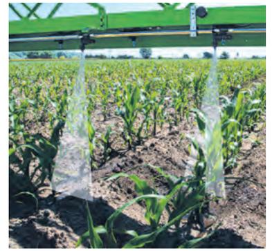
entweder per Hand oder über GPS mit Ackerschlagdatei oder über Kameras automatisch geregelt. Schmale Flachstrahldüsen ermöglichen es, nur 20 bis 30 cm über der Reihe zu behandeln.
