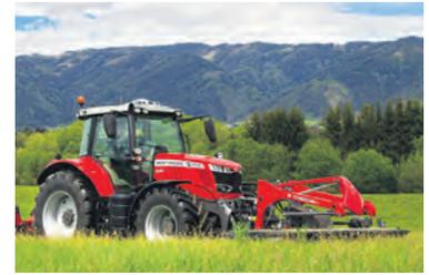
oder dem neuen Dyna-6 Super-Eco Getriebe erhältlich. Diese neueste Version des Semi-Powershift Getriebes ermöglicht es, bei nur 1.500 U/min bis zu 40 km/h zu fahren. Die Betriebskosten werden durch lange Wartungsintervalle reduziert, 600 Stunden für den Motor und 1.800 Stunden für das Getriebe.
