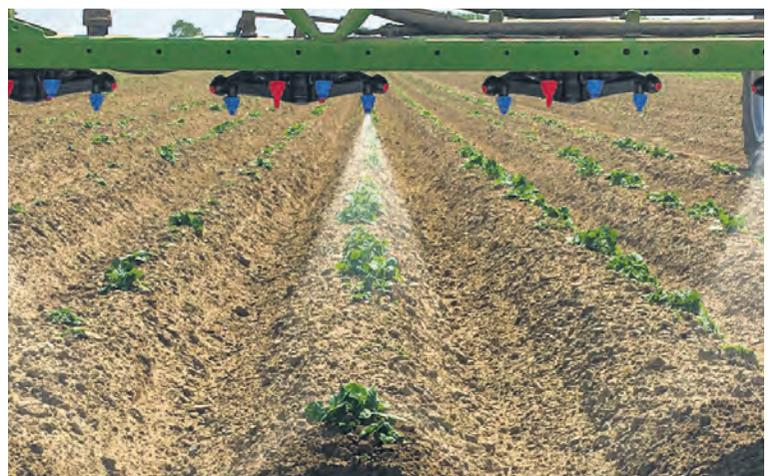
**Der Vierfach-Düsensträger** ermöglicht mit Standard-Feldspritzen eine Bandapplikation in Reihenkulturen ohne Umbaumaßnahmen.
