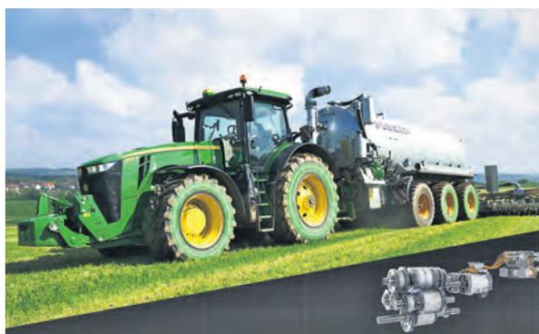
**Teleelektrifizierter Antrieb** mit zwei angetriebenen Anhängerachsen.
