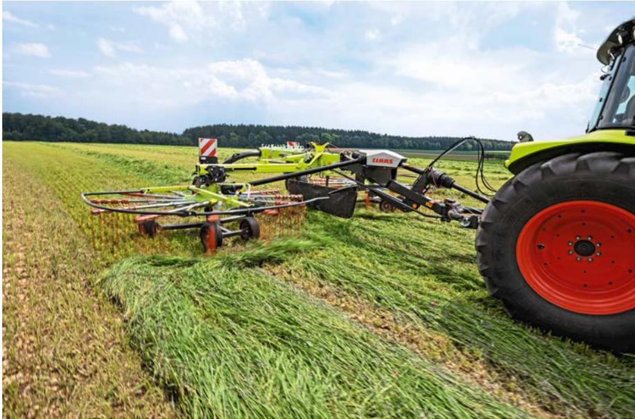
Der weitverbreitete Kreiselschwader ist erhältlich mit einem bis sechs Kreiseln und mit Arbeitsbreiten bis 19 m. Er macht gleichmäßige Schwade. Bei blattrichem Erntegut (z. B. Luzerne) kann es zu Bröckelverlusten kommen.
