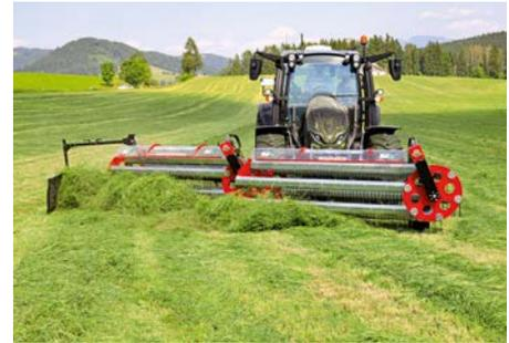
Durch seine Arbeitsweise wird das Futter beim Kammschwader zu sauberen und luftigen Schwaden geformt. Mit drei Schwadtrommeln nebeneinander sind Arbeitsbreiten von 7,5 m im Frontanbau möglich. Foto: Werkbild/BB-Umwelttechnik
