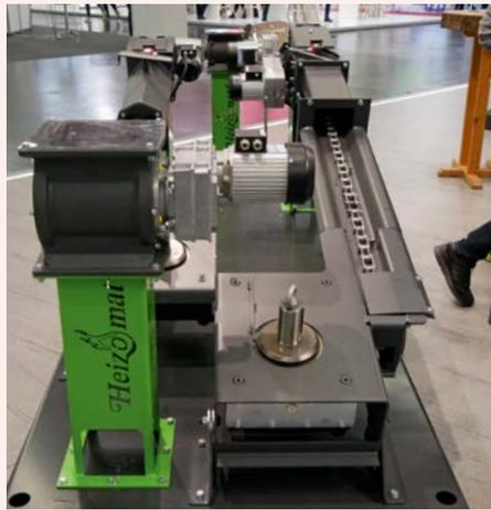
Die patentierte Kettenaustragung von Heizomat
