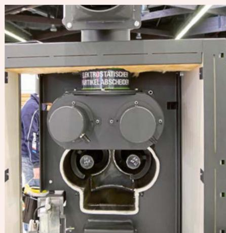
Elektrostatischer Partikelabscheider von Heizomat
