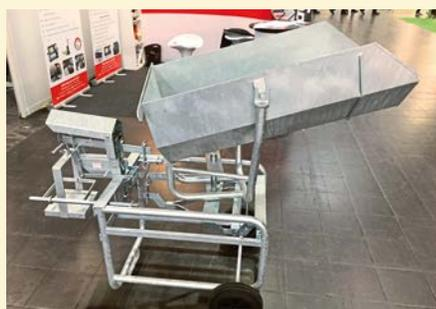
Muldenkipplwaage, rein mechanisch zum Abwiegen bis 100 kg; geeignet für Kohle, Kartoffeln, Zwiebeln, Möhren etc.
