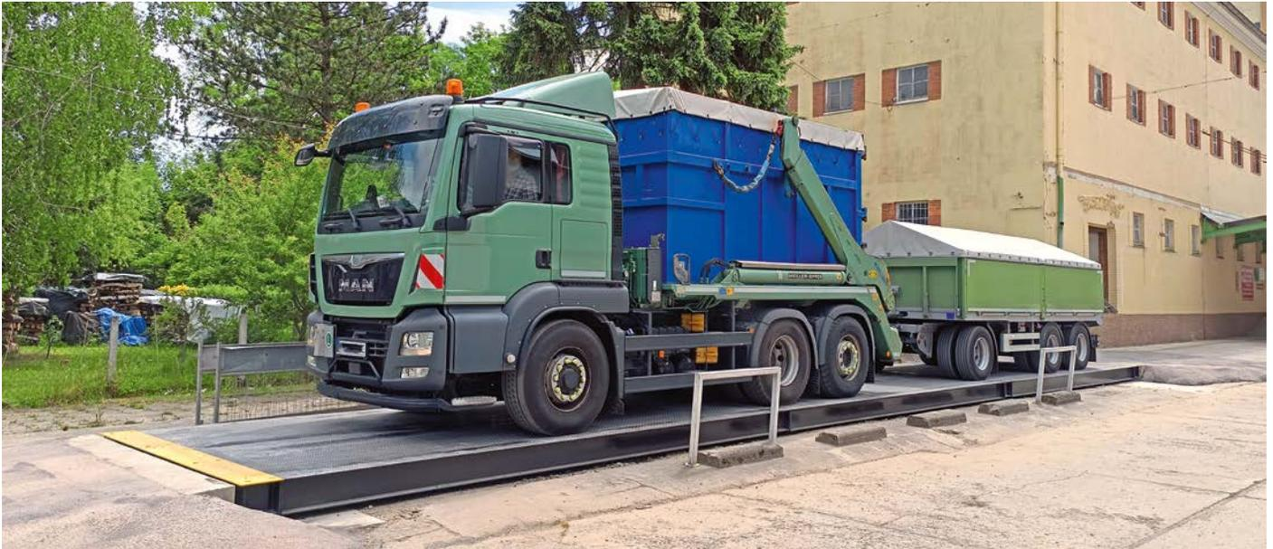
Ersteichung und Konformitätsbewertung mit eigenem 52-t-Eichfahrzeug. Die ursprüngliche alte mechanische Waage war aufgrund von Korrosionsschäden nicht mehr nutzbar. Als günstige Alternative wurde eine Überflur-Stahlwaage in Segmentbauweise eingebaut.
