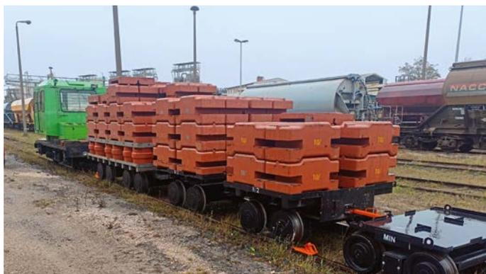
Kalibrierung einer Gleiswaage für bis zu 80 t Gewicht.
