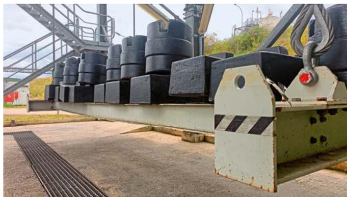
Eichung einer Silobehälterwaage in Zusammenarbeit mit dem Eichamt.
