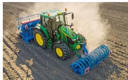
John-Deere-6120M-Traktor mit 133 PS Leistung, AutoTrac-Lenssystem und Niedrighaube bei der Aussaat mit einer Lemken-Saphir-Bestellkombination und VarioPack-Frontpacker.
