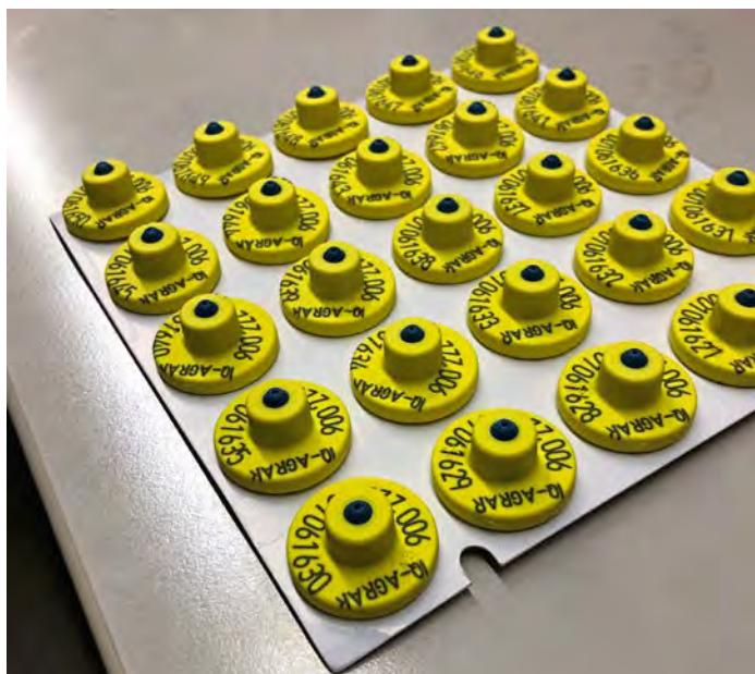
Die elektronischen UHF-Ohrmarke sind Hightech am Ohr. UHF steht für Ultra-Hochfrequenz-Technik.
