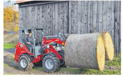
Der elektronisch geregelte Fahrtrieb ecDrive (Electronic Controlled Drive) ermöglicht auch in geringen PS-Klassen eine erhöhte Leistung der Maschine. Bei einem Eigengewicht von 2,7 t beträgt die Kipplast 2,07 t. Die maximale Höhe am Schaufeldrehpunkt beträgt 3 m, die maximale Ausschütthöhe 2,12 m.
