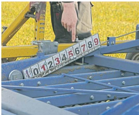
**Skala** zur Anzeige der hydraulisch vom Traktorsitz aus eingestellten Aggressivität des Striegels.
