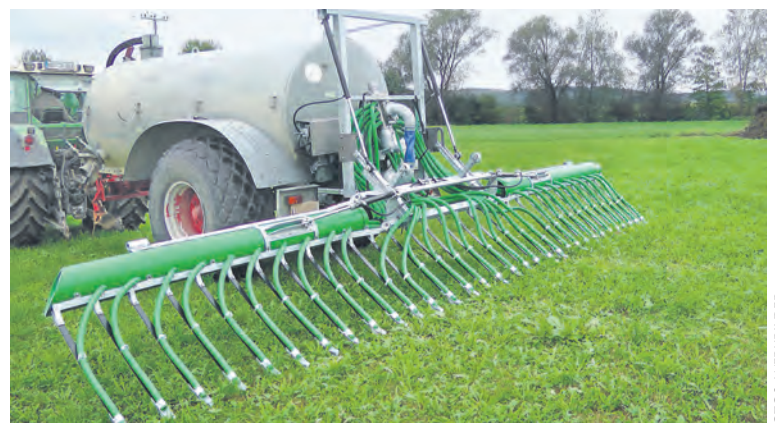
Idee für ein leichtes Gestänge: Einsatz von Kunststoffrohren.
