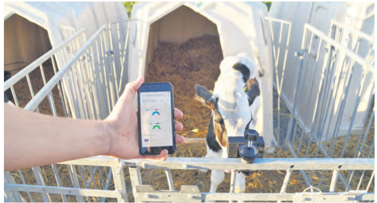
Gesundheitsüberwachung von Kälbern mit passivem Infrarotsensor.
