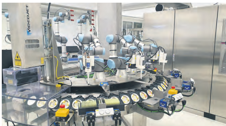
Anlage zur vollautomatischen Geschlechtsbestimmung in Bruteiern.
