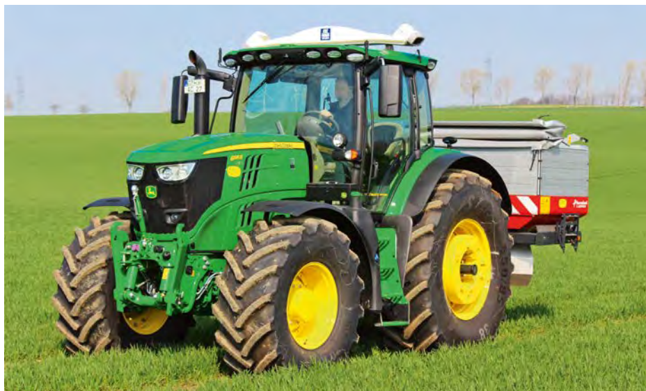
Herbstscan mit einem Yara N-Sensor ALS2®. Werden im Herbst (Oktober/November) Getreidebestände gescannt, so können damit über den Winter Streukarten für das kommende Frühjahr erstellt werden. Damit ist bereits bei der ersten N-Gabe eine teilflächenspezifische Düngung gewährleistet. Fotos: Agricon
