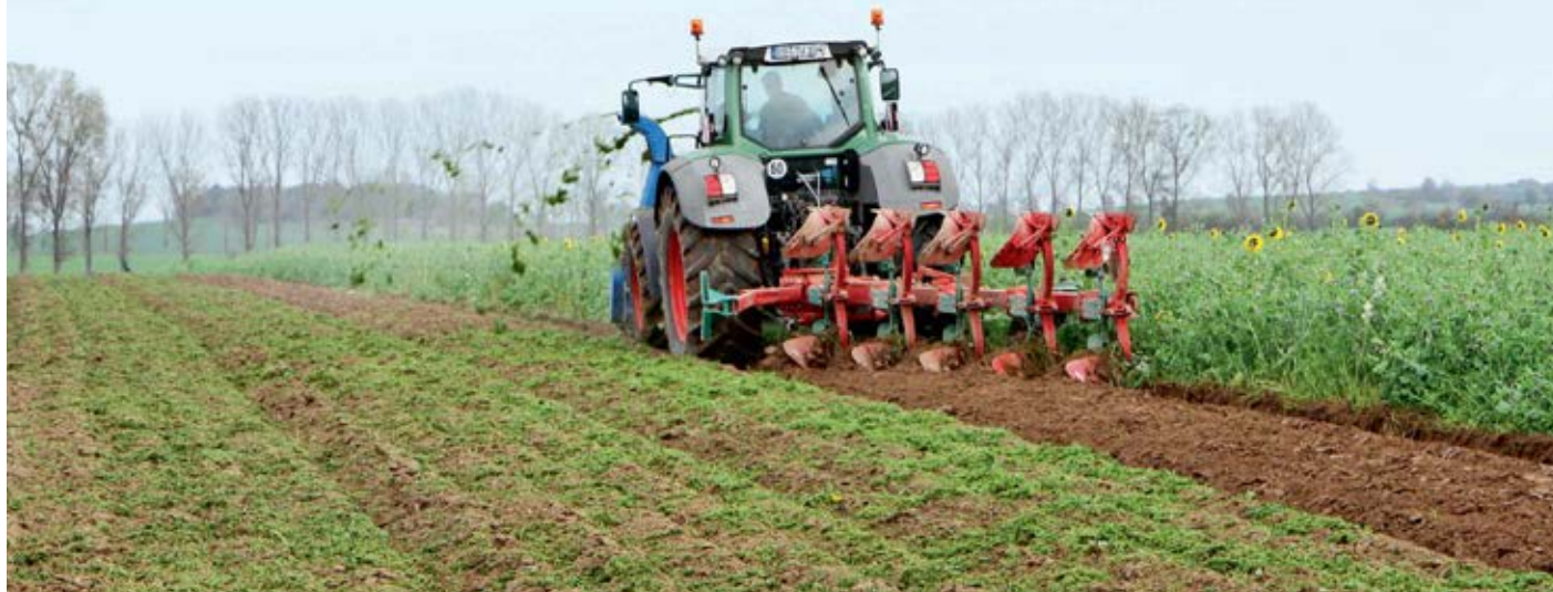
Eine Maschinenkombination aus Spezialmulcher im Frontanbau, Traktor und Pflug ermöglicht auch beim Pflügen das Anlegen einer Mulchschicht zur Verminderung der Erosionsgefahr.
