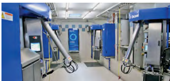
Die Melkroboter VMS V300 von DeLaval sind auf Viertelmelken ausgelegt.
