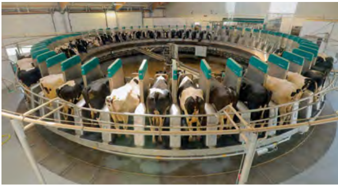
Das automatische Melkkarussell von GEA verfügt über 56 Plätze. Pro Stunde können 250 Kühe gemolken werden.
