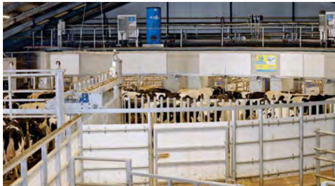
Vom Vorwarthof der Milchviehanlage können die Kühe zwölf Melkroboter aufsuchen. Über den Rücktrieb finden die Tiere wieder zum Stall.
