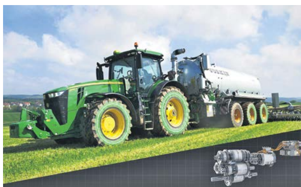
Teilelektrifizierter Antrieb mit zwei angetriebenen Anhängerachsen.
