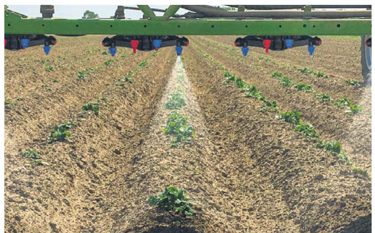
Der Vierfach-Düsenträger ermöglicht mit Standard-Feldspritzen eine Bandapplikation in Reihenkulturen ohne Umbaumaßnahmen.
