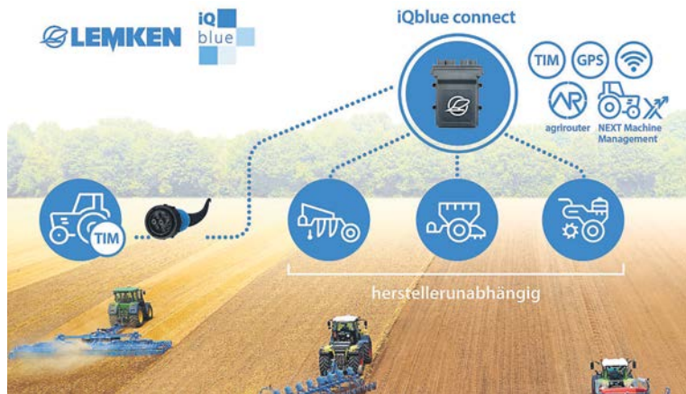
Herstellerübergreifendes , nachrüstbares und portables Modul zur Automatisierung von Gerätefunktionen auf Isobus-Basis.
