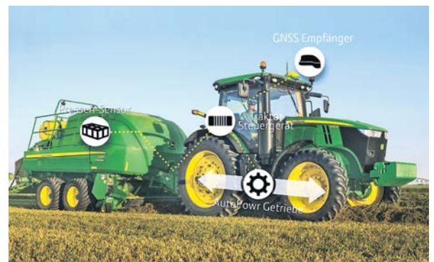
Elektronik macht es möglich: Dämpfung der Schwingungen der Presse.
